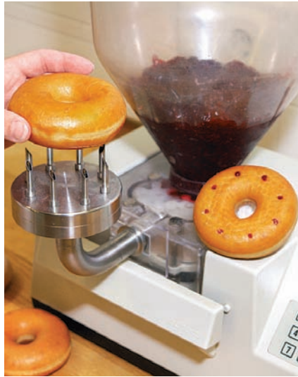
An das Basis-Füllgerät des Meistermarken Service-Clubs passt auch eine kreisrunde Dosiertülle zum Füllen von Donuts.
