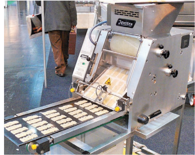
Spekulatius oder Teegebäcke können rationell mit den Formmaschinen der Niederrhein. Formenfabrik Janssen hergestellt werden. Die Gebäcke werden vom Band auf die durchlaufenden Bleche abgelegt.
